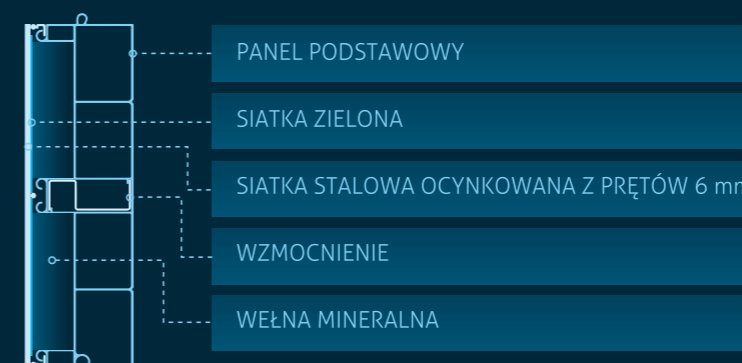
Wersja „B” z dodatkowym wypełnieniem wełną mineralną gr. 4 cm w czterech tylnych komorach. Version „B” filled with additional absorbing material 4 cm in four chambers.
